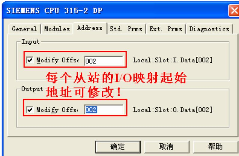
如 CPU315-2 从站已在 STEP7 中完整硬件配置，系统正常，SF 和 BF 灯为常红，可通过 SST-PFB-CLX 提供的搜索功能自动获取从站配置信息！
